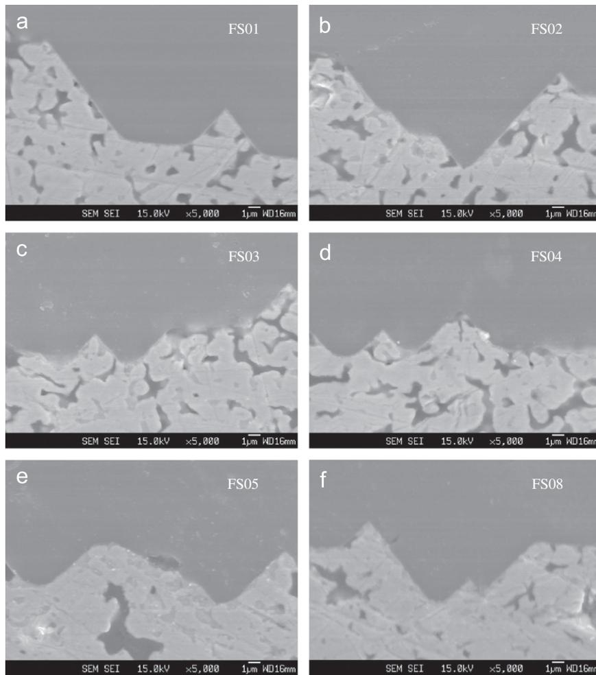
Fig. 7. Cross-sectional SEM images of the Ag–Si contact interface for (a) C1 (FS01), (b) C2 (FS02), (c) C3 (FS03), (d) C4 (FS04), (e) C5 (FS05) and (f) C8 cell (FS08 pastes).
